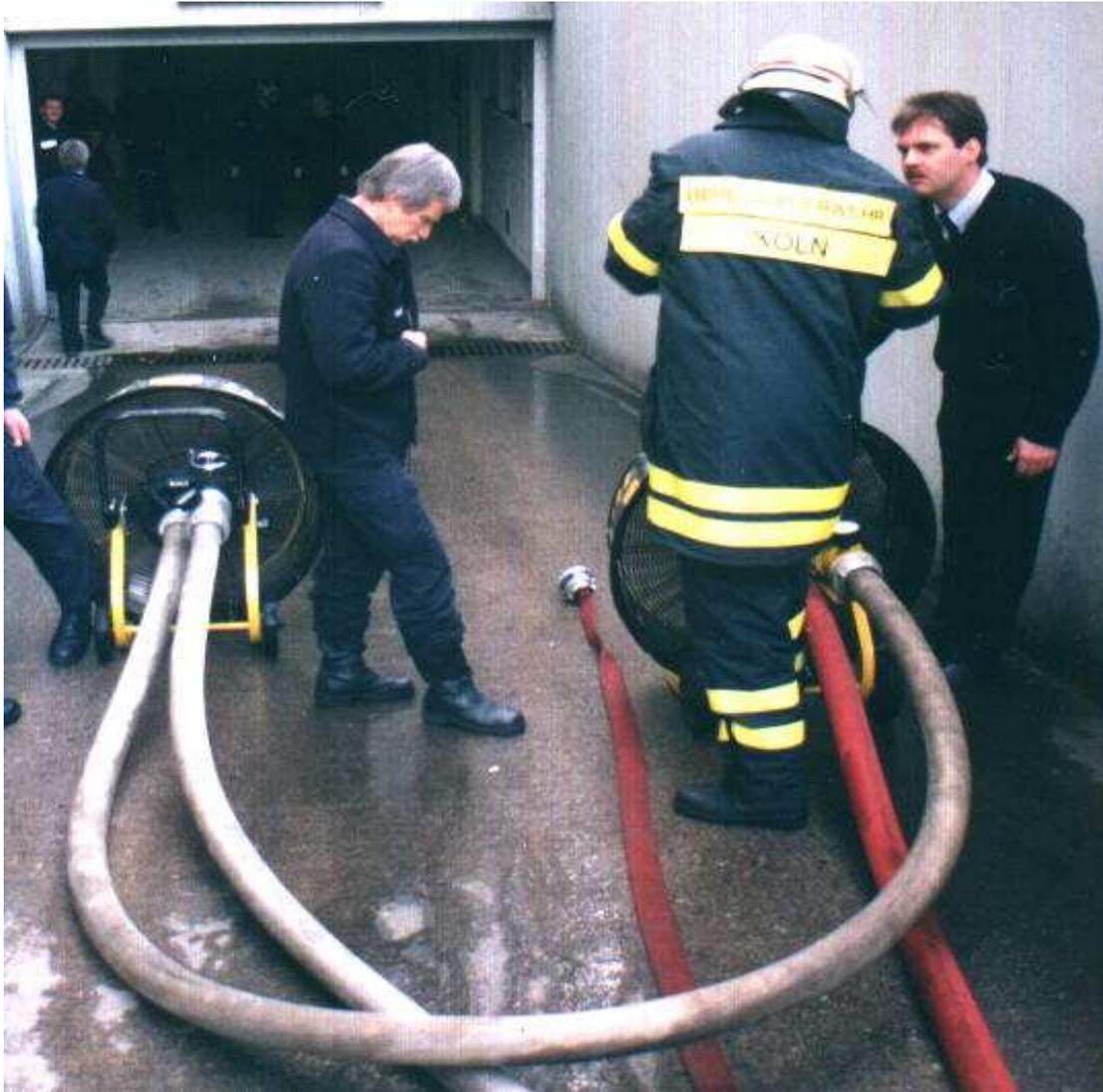
Wasserbetriebene Lüfter können bei Parallelbetrieb in Reihe an einen Förderstrom geschaltet werden.
